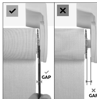
Comprobar que la cortina está correctamente instalada **verificando que el espesor de la llave, coincida con la separación entre el soporte y la contera.**
